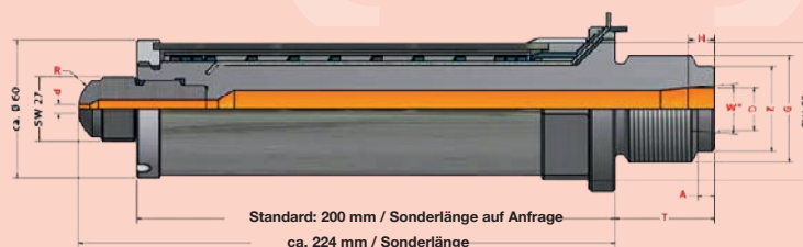
Beispiel für eine kunststoffdichte OFS-Maschinendüse Typ 2 / andere Abmessungen auf Anfrage
